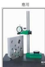
鋼性結構, 適合使用機械或數位式量表(測力變化比較大)作對比高度測量(首先用塊規對零, 然後測量工件高度)
