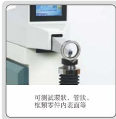
可測試環狀、管狀、框類零件內表面等
