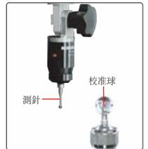
測針(選配), 包含 $\varnothing 2\text{mm}$ 和 $\varnothing 3\text{mm}$ 測針,  $\varnothing 25\text{mm}$ 校准球, 測量精度 $10\mu\text{m}$
