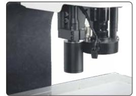
光譜共焦傳感器(選配), 可根據折射率測量玻璃或塑料薄膜的厚度, 測量精度 $5\mu\text{m}$
