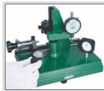
檢測針盤式量表的測力
