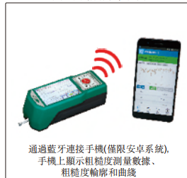
使用手機操作粗糙度儀
