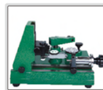
檢驗杠杆針盤式量表的精度
