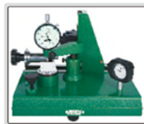
檢測針盤式量表的重複性
