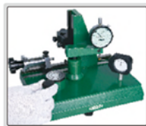
檢測針盤式量表的測力
